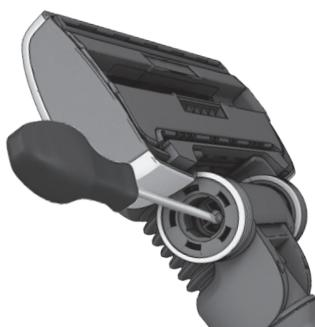
Csavarozza ki a keréktengelyt, és tisztítson meg minden alkatrészt. Az összeszereléshez végezze el a fenti műveleteket fordított sorrendben.
