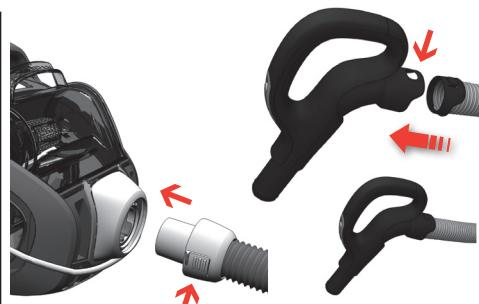
**Вставьте шланг** (чтобы снять его, нажмите кнопки фиксатора и вытяните).
