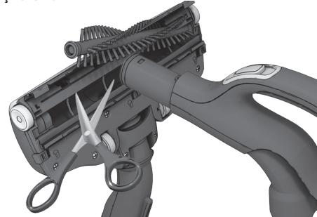
Izvlecite valjček ščetke in s škarjami odrežite niti, ki so se zapletle vanjo. Nastavek očistite z ročajem upogibljive cevi. Dele znova namestite v obratnem vrstnem redu, kot ste jih odstranili.
