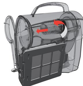
Odstranite ciklonski filter, tako da ga povlečete iz ohišja filtra.
