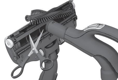
Scoateți afară ruloul cu perii și îndepărtați firele încâlcite tăindu-le cu o foarfecă. Folosiți mânerul furtunului pentru a curăta duza. Montați la loc componentele, procedând în ordine inversă.
