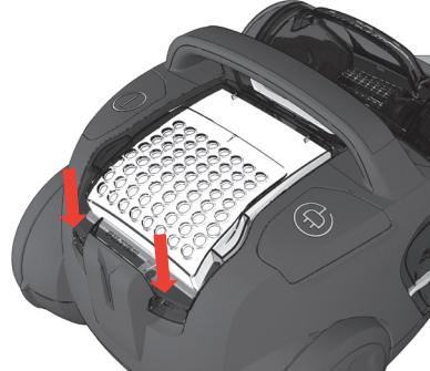
Pokrov potisnite naprej in ga pritisnite navzdol.
