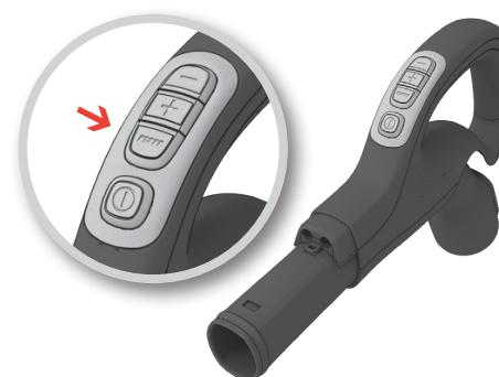
**Modely s dálkovým ovládáním a motorizovanou hubicí AeroPro.** Chcete-li motorizovanou hubici zapnout nebo vypnout, stiskněte tlačítko BRUSH na rukojeti. Když je funkce kartáče aktivní, kontrolka na hubici se rozsvítí.
