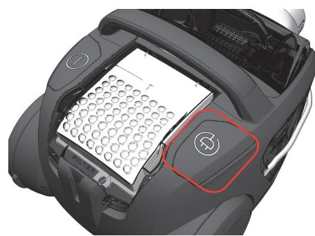
După aspirare, **înfășurați cablul de alimentare prin apăsare pe butonul ÎNFAȘURARE.**
