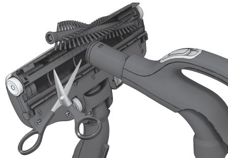
Vyjměte válcový kartáč a odstraněte namotané nitě. Hubici vyčistěte pomocí koncovky hadice. Vratte součásti na místo v obráceném pořadí.
