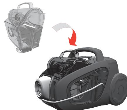
Vložte prachový kontejner zpět tak, aby s klapnutím zapadl na své místo.
