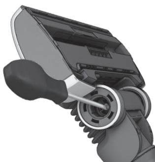
Deșurubați axul roților și curătați toate piesele. Montați la loc componentele, procedând în ordine inversă.
