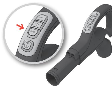
**Modeli z daljinskim upravljanjem in sesalnim nastavkom z motorčkom AeroPro.** Za vklop in izklop sesalnega nastavka z motorčkom pritisnite gumb za ščetko, ki je nameščen na ročaju. Ko je ščetka aktivna, je kontrolna lučka na sesalnem nastavku prižgana.
